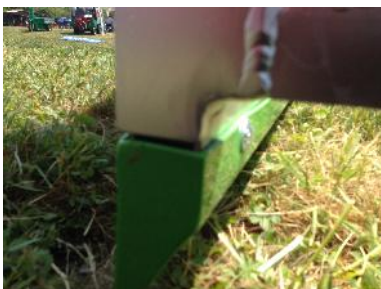
Schneidkante stabile Ausführung aus Stahl auch bei Aluminiumkästen
