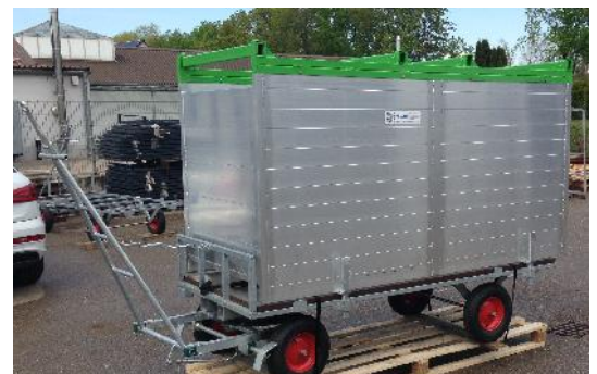
Transportwagen Optional für den sicheren Transport des Gleitschalkastens. Ausführung: • Alle Stahlkomponenten verzinkt • Großer Drehkranz • seitliche Aufnahmen für optionale Rungen • Siebfilm-Bodenplatte
